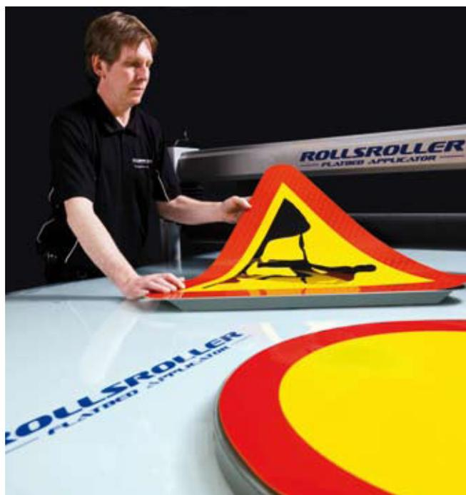
*La ROLLSROLLER est une machine à laminer tous types de film adhésif. Par exemple les panneaux de signalisation*
